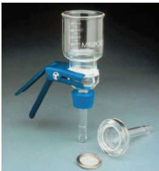
Figura 5. Sistema de filtrado para recogida de ovocitos bovinos.
